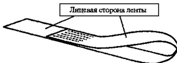
Рис. 6. Скрученная петля стропа
