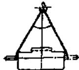
Схема строповки вкладыша
