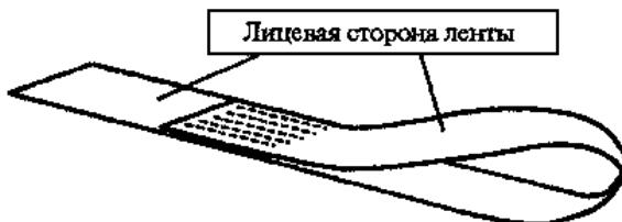
Рис. 6. Скрученная петля стропа
