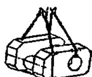
Схема строповки детали пресса
