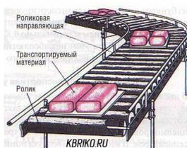
Рис. 1-108. Роликовый конвейер.
