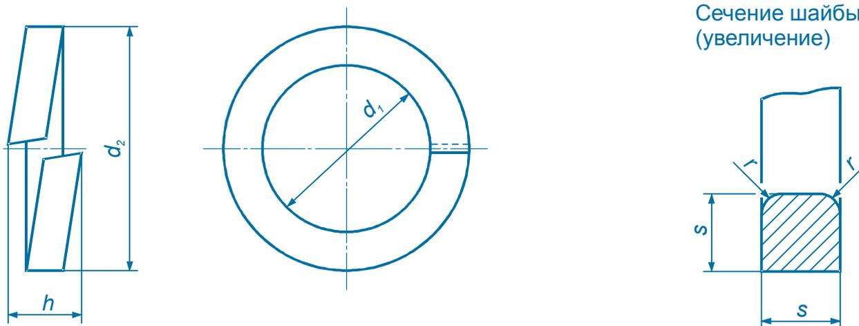
На чертеже показано обозначение размеров пружинных шайб DIN 7980, предназначенных для комплектации винтов с цилиндрической головкой с правой резьбой. Для крепежных изделий с левой резьбой следует использовать зеркально отраженное изображение шайб.
