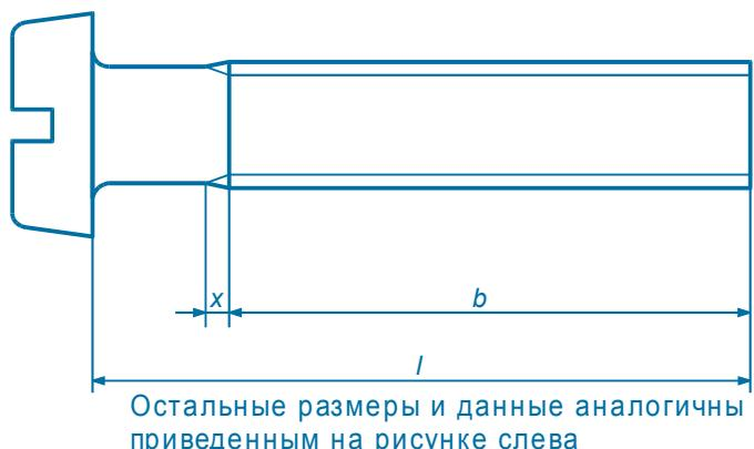
Диаметр гладкой части стержня винтов с резьбой на всей длине равен номинальному диаметру резьбы, а винтов с резьбой на конце стержня – среднему диаметру резьбы. Размеры определяет производитель.
